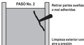
En grietas o fisuras verticales, soplear con aire a presión para retirar partes flojas o sueltas. Sobre la grieta o fisura haga una perforación a cada 15 o 20 cm con una profundidad de 3 a 5 cm con un diámetro de 1/4" o 3/8" y con una inclinación de 15 positivos. Inserte tubos de cobre o de plástico en las perforaciones anteriores, quedando sobresalidos unos 3 cm.
